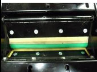
Cambiar con el nuevo rotor, cuidado : la colocación de las lengüetas de goma es muy importante para la distribución de las semillas. Posición original del muelle en la parte inferior (en el reloj)":6h00-7h00-Posición original del muelle en la parte superior (en el reloj) :12h00.
