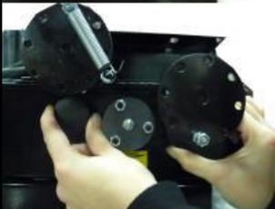
3. Desenrosque las dos tapas del rodamiento.
