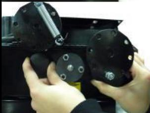
3. Desenrosque las dos tapas del rodamiento.
