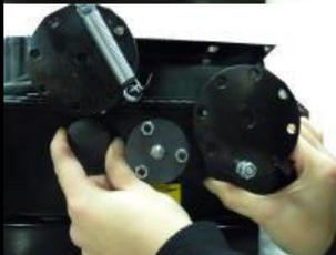
3. Desenrosque las dos tapas del rodamiento.
