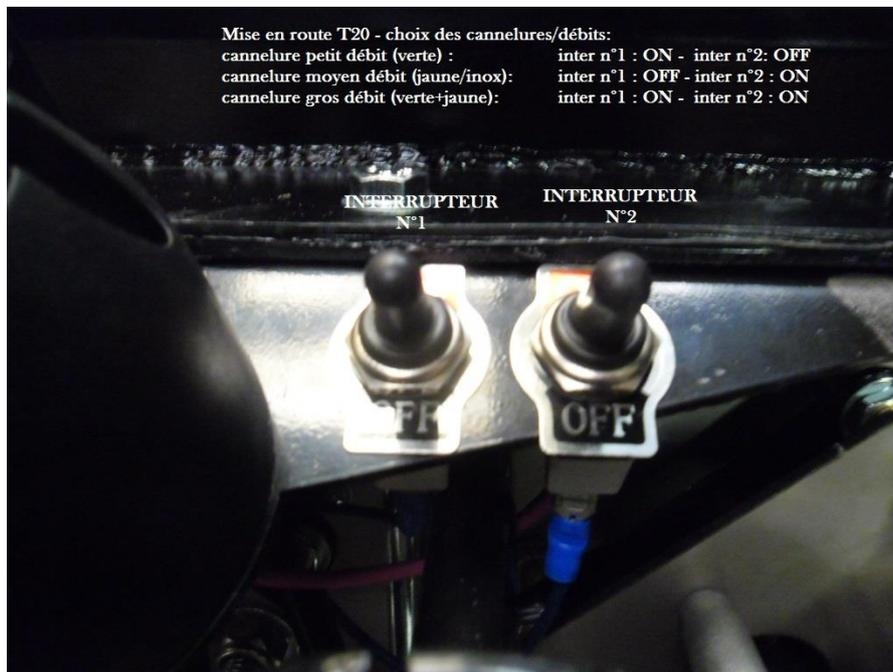
*Coloque correctamente los interruptores situados cerca de los surcos seleccionando el surco o el caudal que desea accionar.*
