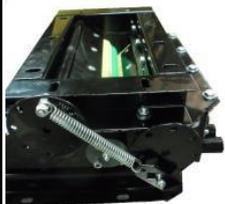
Positionnement correct de la cannelure de distribution, des bavettes et du ressort
