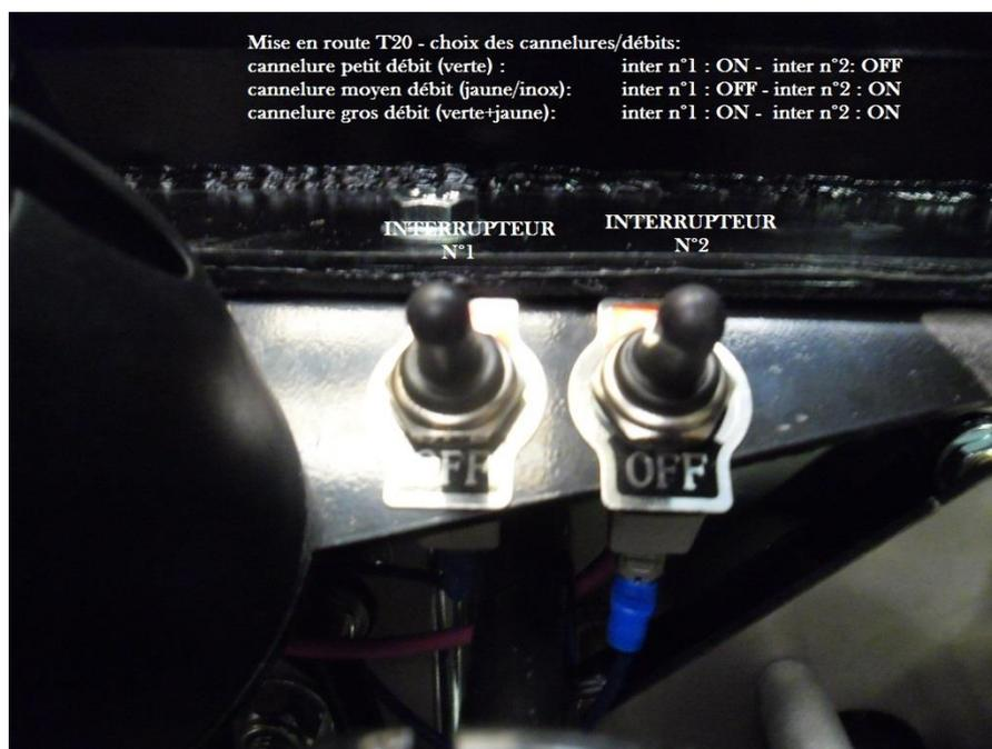
*Positionnez les interrupteurs situés près des cannelures de manière correcte en sélectionnant la cannelure ou le débit que vous désirez actionner.*
