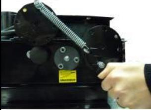
1. Posición original del muelle en la parte inferior (en el reloj):6h00
