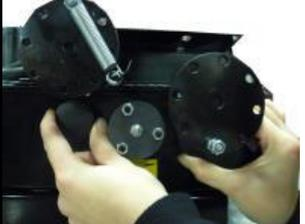
3. Desenrosque las dos tapas del rodamiento.
